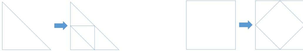
Figure 4 : raffinement d'une structure triangle (à gauche), d'une structure quadrilatère (à droite)
