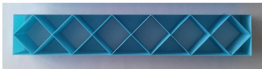
Figure 2 : Pièce étudiée, imprimée par extrusion en continu
