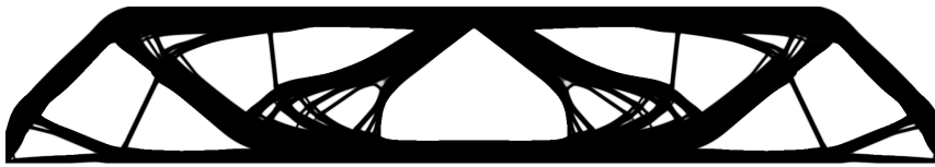
FIGURE 1 – Exemple d'optimisation topologique d'une poutre en flexion.
