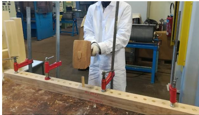
Figure 3 – Assemblage de poutres bois multicouches par tourillons
