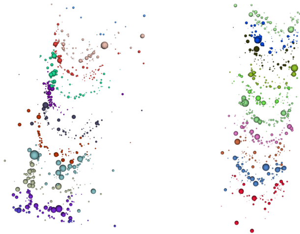
FIGURE 4 – Population de défauts observée (à gauche, les défauts sont représentés par leur sphère équivalente) et simulée (à droite).
